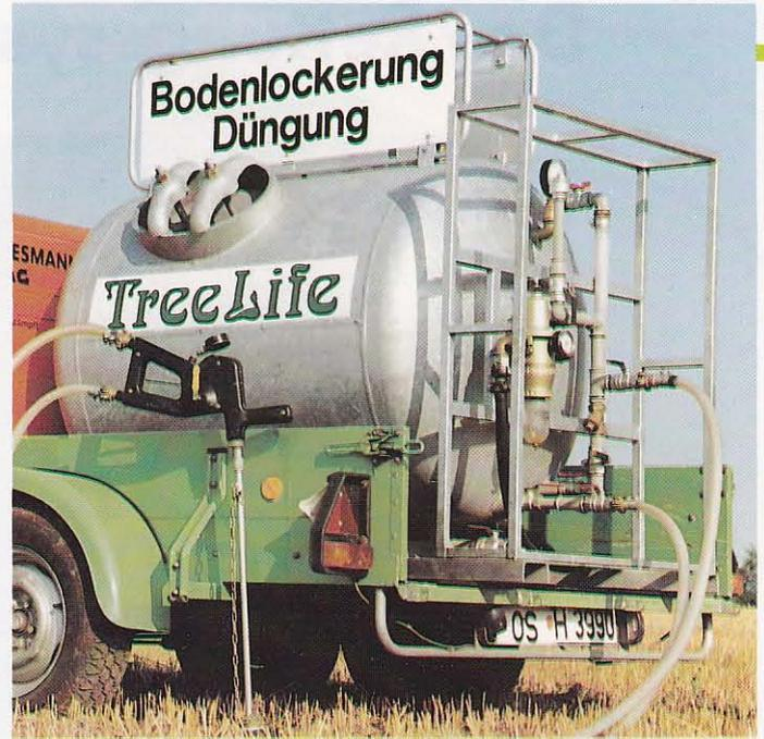
**TreeLife** ist in wenigen Minuten einsatzbereit! Über Druckschläuche werden ölfreie Preßluft und in Wasser gelöste Bodenverbesserungsmittel / Dünger zur Injektionslanze transportiert.
